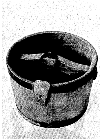
図68 撈釣瓶の桶 (法量) 高さ二五・五寸、口径三二・五寸、底の径三〇寸。(材質) 桶のたがは鉄、おもりは鉛。(解説) 井戸から水を汲み上げる時に使うはねつるべの桶である。桶にはおもりがついており、そのために桶が傾いて水が汲みやすくなっている。所有者は昭和三十年ごろまで、この桶のついたはねつるべを畑で使っていた。
