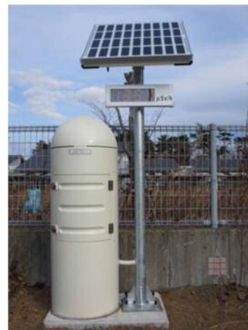
リアルタイム線量測定システム 出典：環境白書（平成26年度版）
