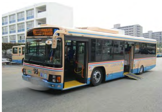
ノンステップバス、スロープ板の様子
