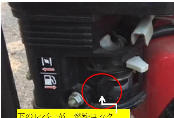
燃料コックを左に動かし、“OFF”にします。そのまま運転を続け、エンジン内に残った燃料を使いきるまで電源を切らないで自動的にエンジンが停止するのを待ちます。
