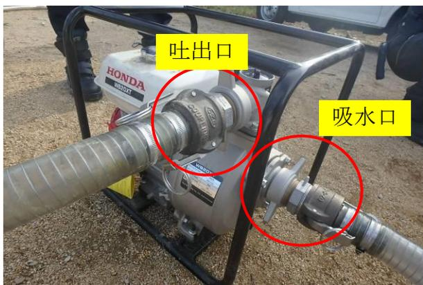
給水ホース (短い/太い) をエンジンポンプの吸込口に差し込みます。
