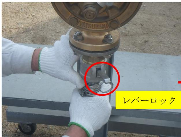
給水ホース（短い／太い）をウイングポンプの吸水口に差し込みます。
