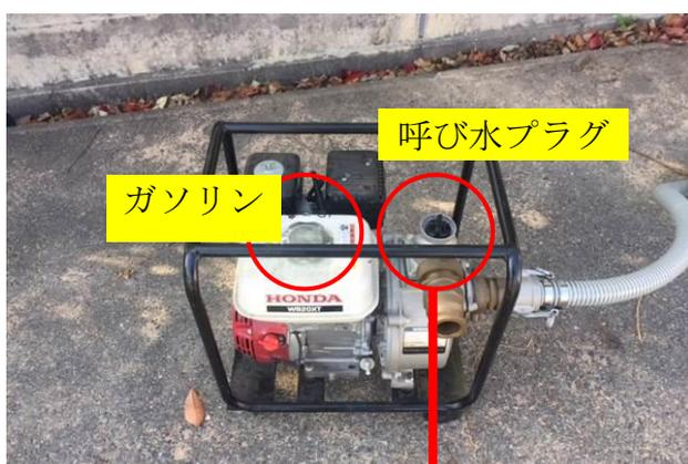
給水ホース（長い／細い）を給水スタンドの吸水口とエンジンポンプの吐出口に差し込みます。なお、給水スタンドの蛇口は必ず開けておきます。
