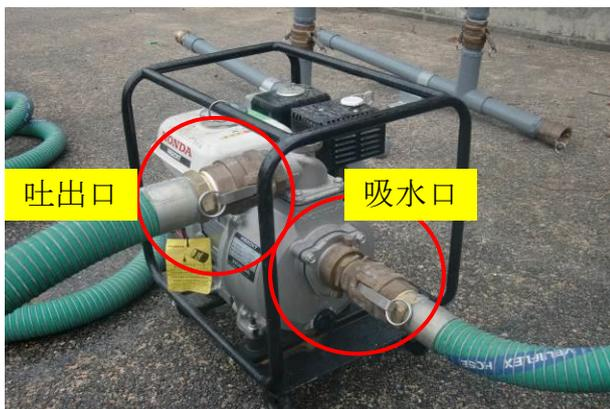
給水ホース (短い/太い) をエンジンポンプの吸水口に差し込みます。
