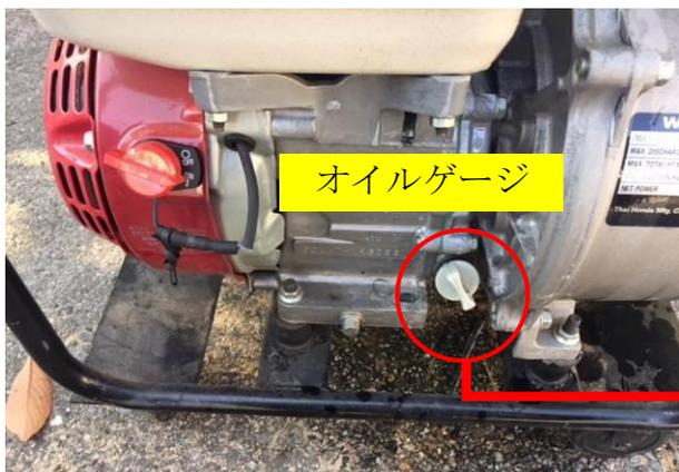
オイルゲージを開けて、エンジンオイルを確認します。オイルゲージの先部分のみしかオイルで濡れていなければ、(オイルゲージに) オイルを給油します。
