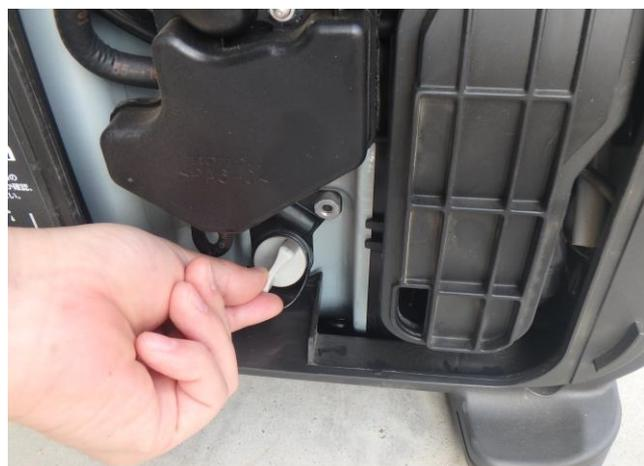
※オイル給油キャップは確実に締め付けてください。締め付けがゆるいとオイルが漏れることがあります。
