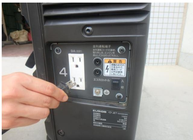
接続電気機器のスイッチが切られていることを確認し、コンセントへ使用機器のプラグを差し込みます。
