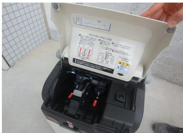
ボンベカバーを開け、操作レバーが【解除】の位置にあることを確認します。
