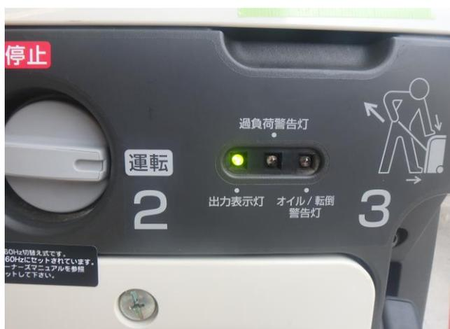
接続電気機器のスイッチを入れます。正常運転の場合は、出力表示灯（緑）が点灯し続けます。
