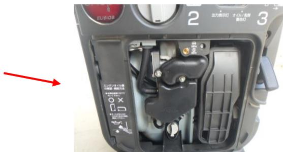
オイル給油キャップを外し、オイル給油口の口元までオイルがあるかを確認します。
