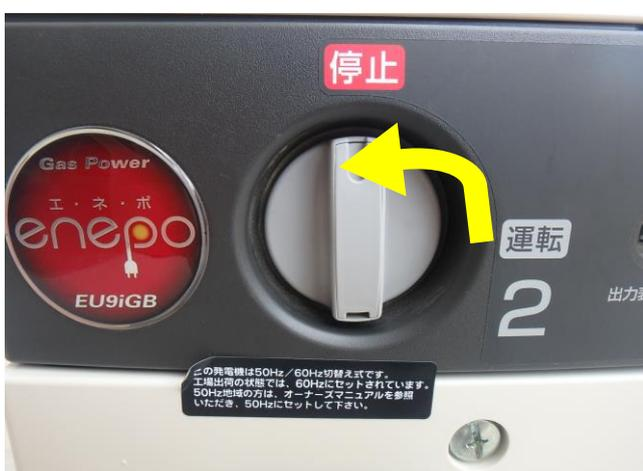
エンジンが自動的に停止後、エンジンスイッチを“停止”の位置に合わせます。
