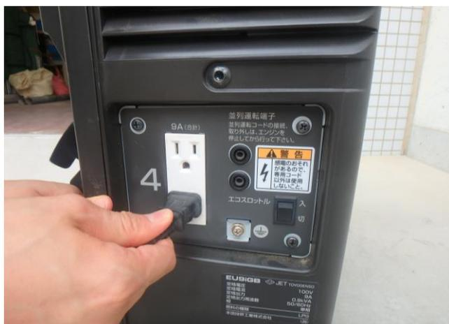
接続電気機器のスイッチが切られていることを確認し、コンセントから使用機器のプラグを抜きます。
