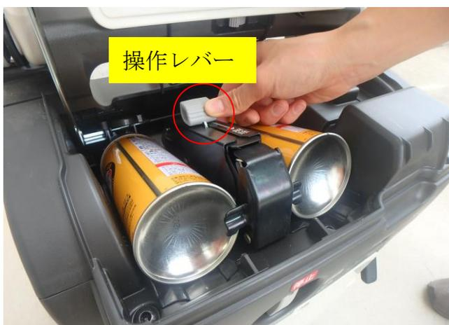
操作レバーを【解除】から【固定】にスライドさせ、ボンベカバーを閉じます。
