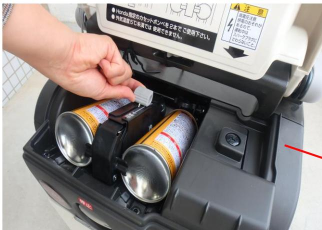
運転停止後、ボンベカバーを開け、操作レバーを【固定】から【解除】にスライドさせ、カセットボンベを2本取り外します。
