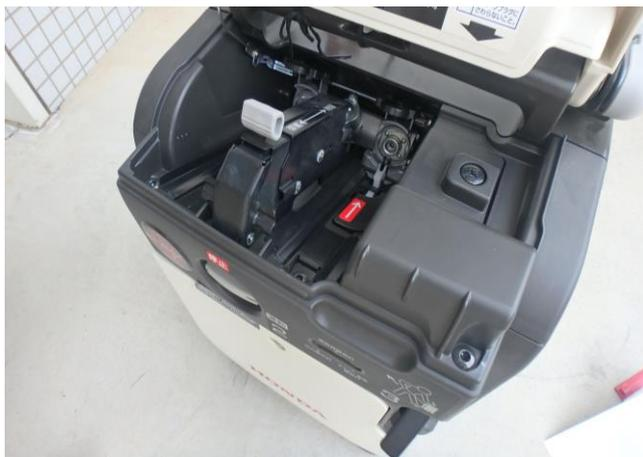
カセットボンベが入っていない状態で運転（残留ガスでの運転）し、発電機内に残ったガスをすべて使い切ります。
