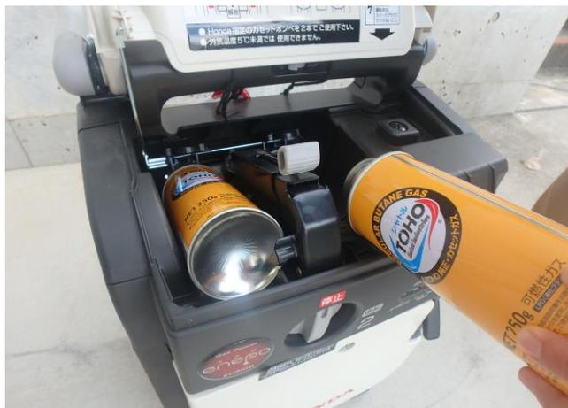
カセットボンベを先端から奥に差し込みます。同様の手順で2本目もセットします。
