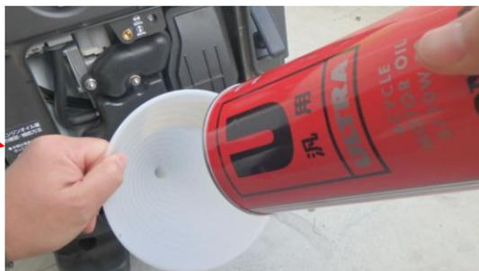
補給後は、オイル給油キャップをゆるまないように確実に締め付けます。
