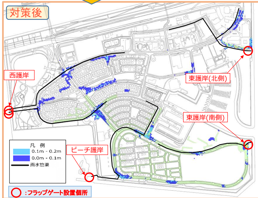
高潮時には海側からの水圧でゲートが閉まる
