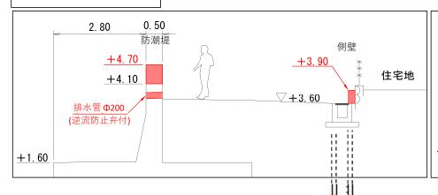
※集水桝底部にも逆流防止弁を設置します
