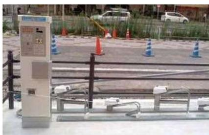
図 2. 機械精算式ラック（バッテリー式）
