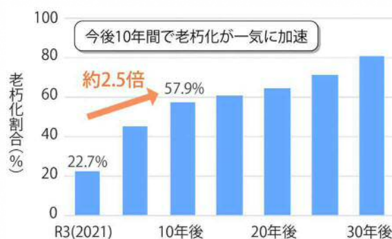
図2 管路の老朽化予測
