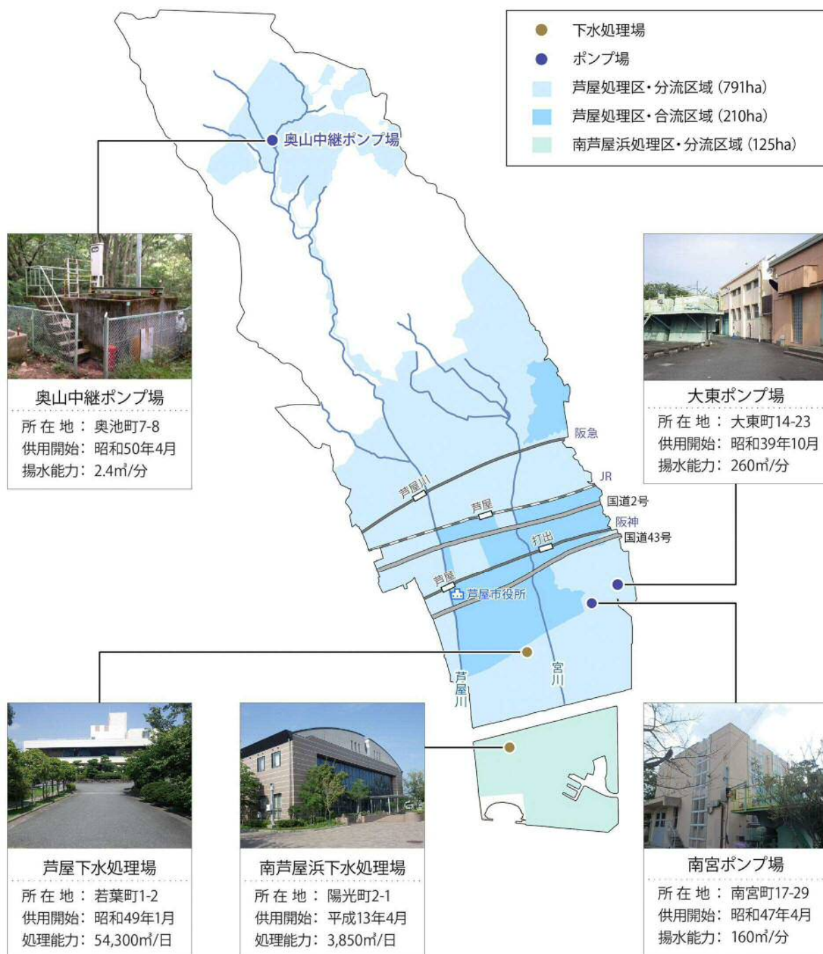
図 1 本市の下水道施設
