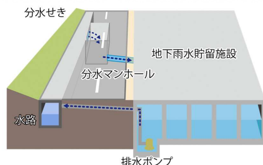
図 18 地下雨水貯留施設
