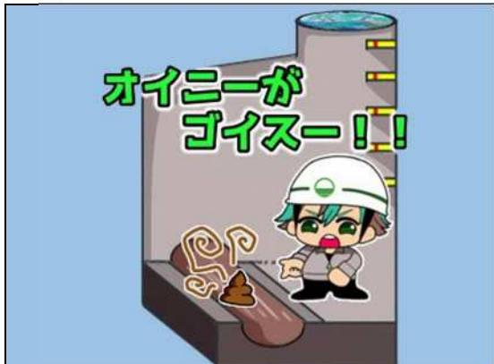
マンホールの中は、下水道施設の点検ができるよう空間が、広がっています。マンホールから、テレビカメラを入れて、下水道管の状況を確認したり、管の清掃を行ったりする事ができます。
