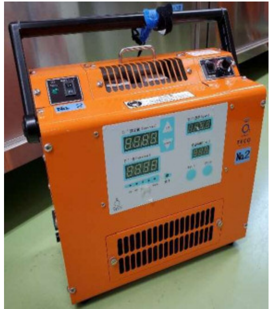
＊ オゾンガス発生装置
