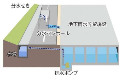
図 18 地下雨水貯留施設
