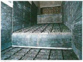
火格子 燃焼経路も高圧ロム耐熱耐腐蝕耐熱の圧力変動耐火格子(鋼)で構成され、耐用性を高める反転クレーン機構も備えています。
