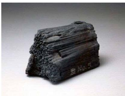
これは高熱火災にあった縫い針です。原爆のさく裂と同時に放射された強烈な熱線により、市内中心部の家屋が自然発火し、続いて市内のいたるところで、火の手があがりました。爆心地から半径2km以内の地域はことごとく消失し、すべてのものが異常な高熱火災により溶けて、まるで溶岩のようにあたりを埋め尽くしました。
