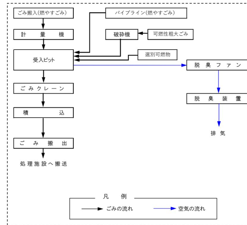
図13-1 中継施設の処理フロー図
