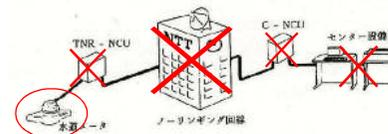
※屋外の電子式リモート水道メーターを直読式水道メーターに取替える。
