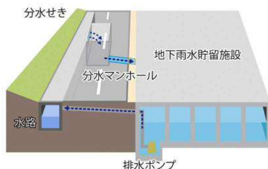
図 18 地下雨水貯留施設
