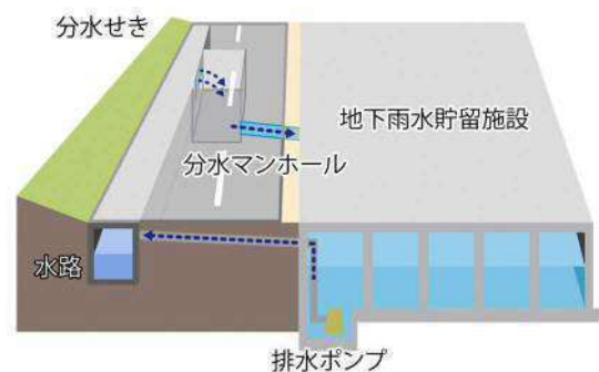
図 18 地下雨水貯留施設
