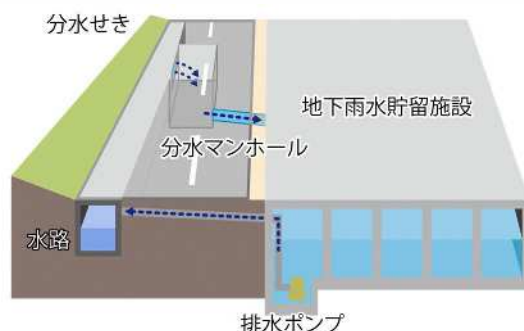
図 18 地下雨水貯留施設
