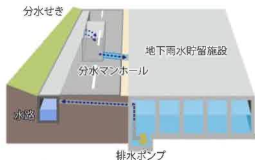
図 18 地下雨水貯留施設
