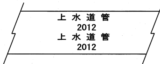
図 3.8-2 埋設管明示テープ
