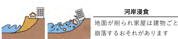
図 - 家屋倒壊等氾濫想定区域での災害のイメージ
